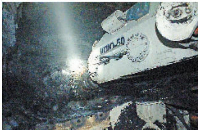
*Проходческий комбайн КПЮ-50 проходит испытания на шахте «Заречная»*
