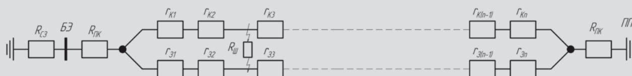
Рис.1. Схема замещения цепи заземления в кабеле и виды воздействия
