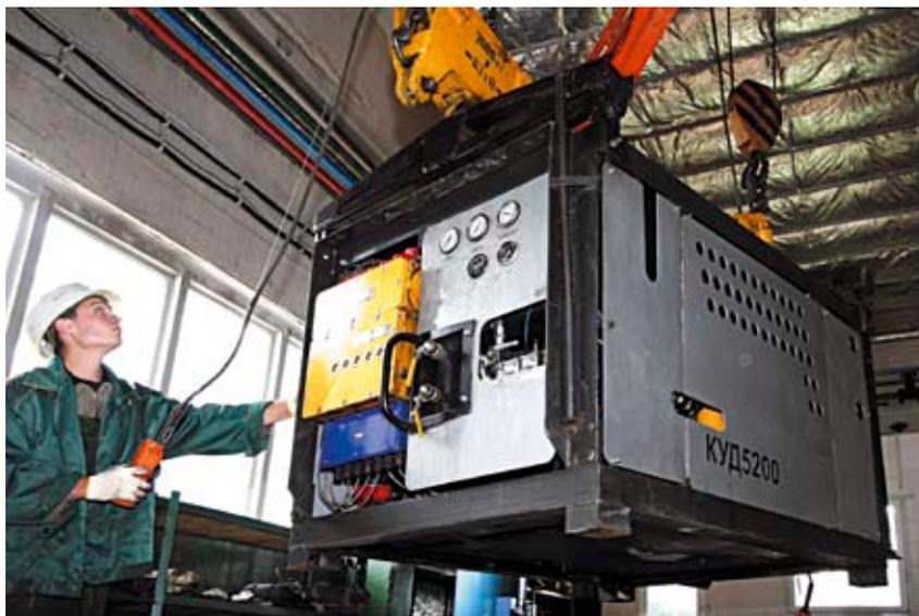
Что еще интересно: «Пургу» можно закрепить на пневматическую маневровую тележку, добавить грузовую балку и сформировать компактную передвижную установку — удобный и маневренный «дизелевоз» грузоподъемностью до 5 тонн. Подвижная техника успешно решит проблемы транспортировки мелких грузов в «тупиковых» условиях недостатка воздуха, обеспечивая работу проходческих или ремонтных бригад.
