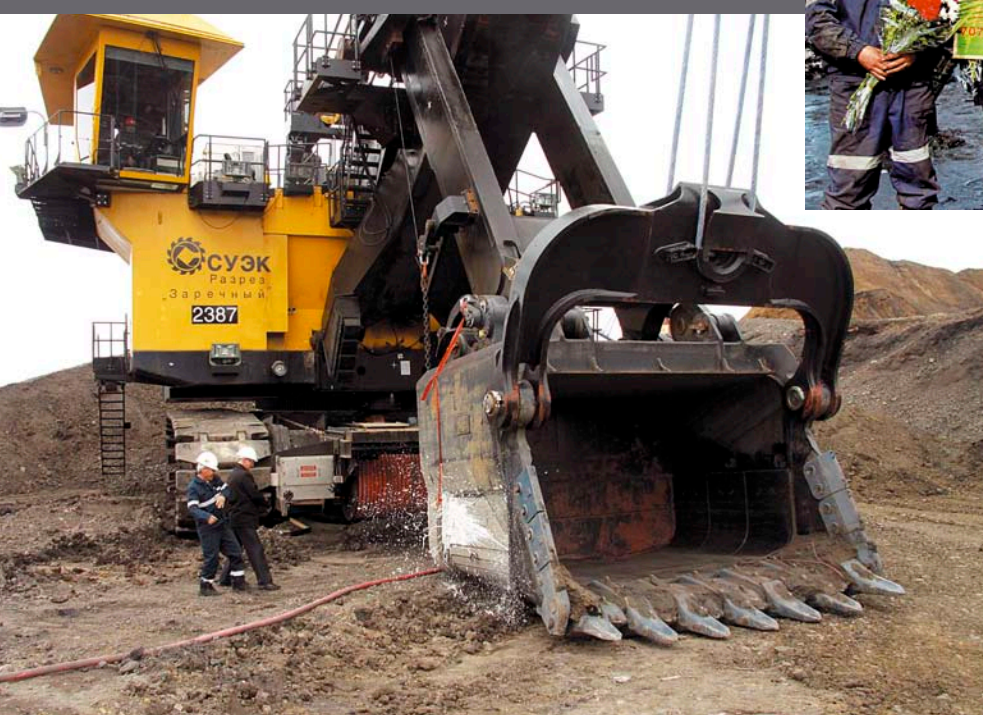
На разрезе «Заречный» торжественный запуск экскаватора P&H2300XPC «P&H Mining Equipment» (США) с объемом ковша 26 кубических метров
