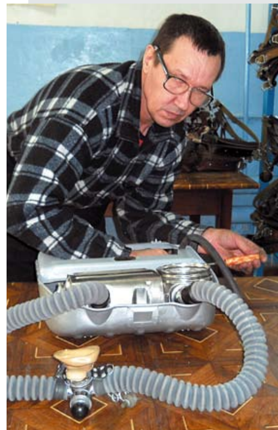
Строгую проверку проходят все детали ОВА-50; технический осмотр и ремонт респиратора ведут опытные специалисты ООО «Горноспасатель»
