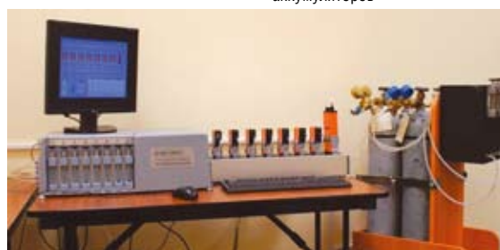
СЭП — автоматизированные стенды для проверки по ПГС, корректировки и диагностики ИКГ-6М и ИКГ-9
