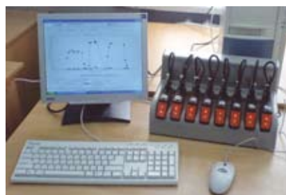
БПСИ — устройства для диагностики и считывания данных из ИКГ-6М одновременно с зарядом аккумуляторов
