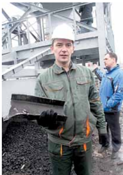
Недробимый предмет — швеллер — после многократного прохождения через дробилку Gundlach, оснащенную системой NITROIL
