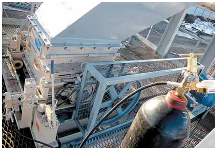
Элементы управления системой регулировки размера дробимого продукта и сброса недробимого предмета — NITROIL — на двухвалковой дробилке Gundlach 3030S
