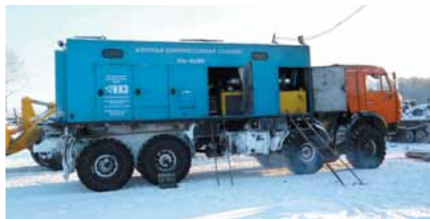
Самоходная азотно-компрессорная станция ТГА на шасси «КамАЗ»
