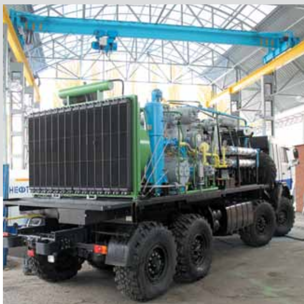
Самоходная азотно-компрессорная станция ТГА на шасси «КамАЗ»
