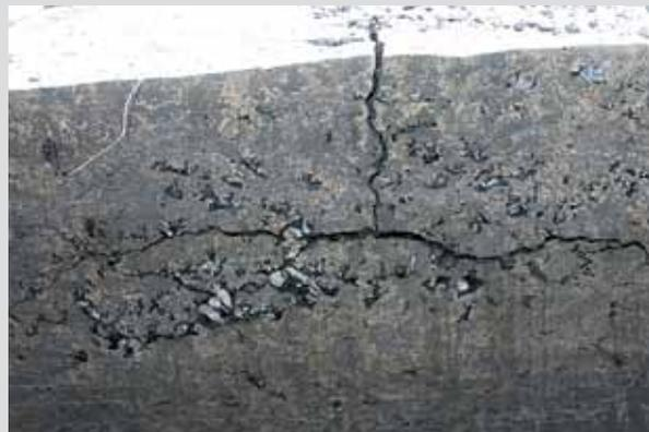
**Развитие трещин после двух импульсов**
