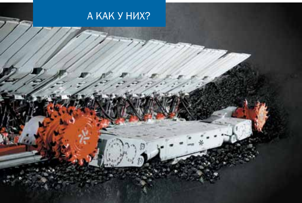
УКД-400 — очистной комбайн порталного типа производства компании Comit, эффективный при разработке тонких пластов со сложной геологией. Используется в горных выработках в комплексе с механизированной крепью и конвейером.
